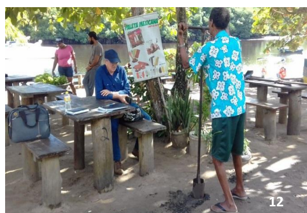
Fotos 11 e 12- Furos à trado para verificação da profundidade do lençol freático. Foto 11 na rua de acesso à rua principal; foto 12, na rua principal.
