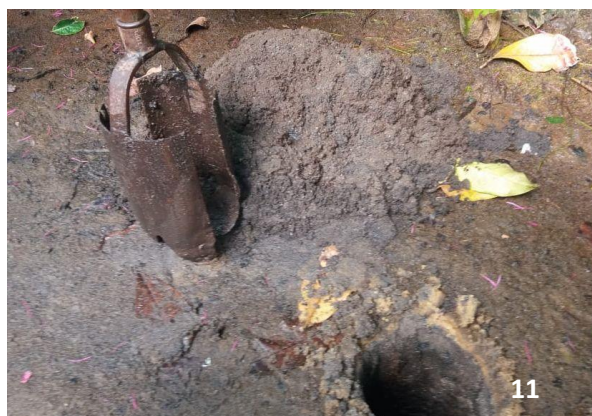
Fotos 11 e 12- Furos à trado para verificação da profundidade do lençol freático. Foto 11 na rua de acesso à rua principal; foto 12, na rua principal.
